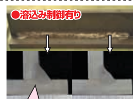
溶込み深さ一定で融合不良なし
